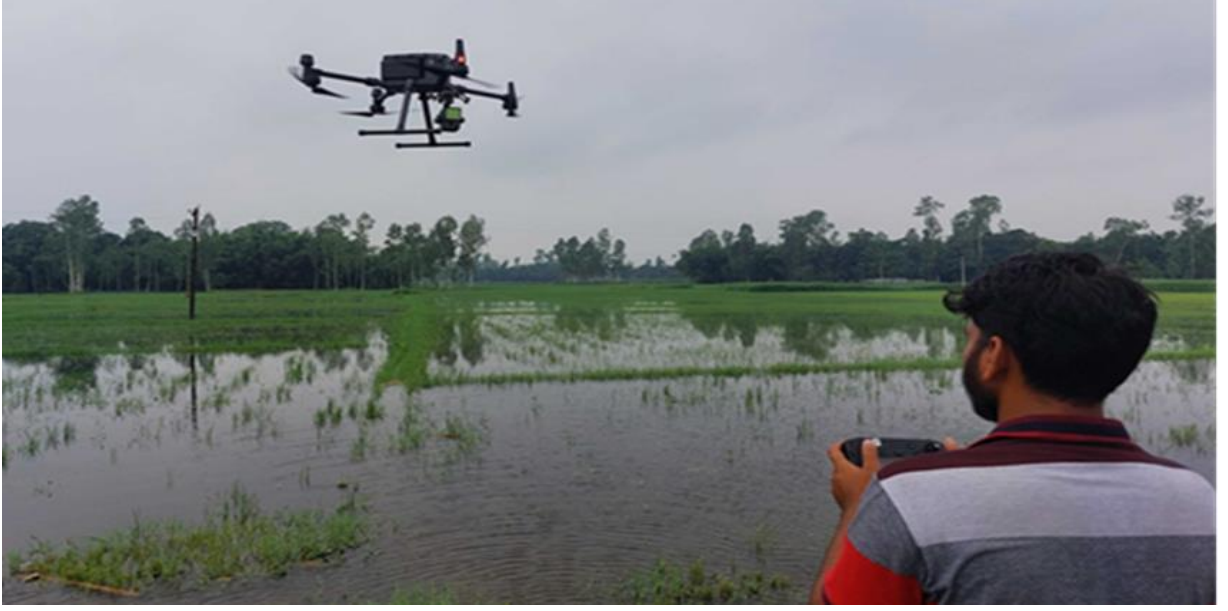
চিত্রঃ ০৬ প্রভাতী প্রকল্পের অধীনে গাইবান্ধা জেলায় LiDAR সেন্সার ও ডোন ব্যবহারের মাধ্যমে পরিচালিত ভূস্থানিক জরিপ।
